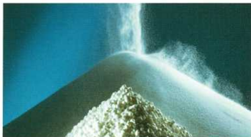
粉末状の塩化ビニル樹脂とベレット状のコンパウンド
