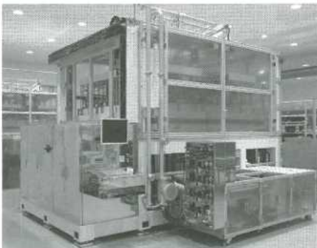
液晶表示装置の自動重ね合わせ装置
